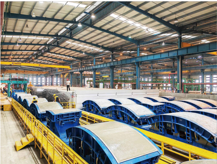
地铁管片生产线
