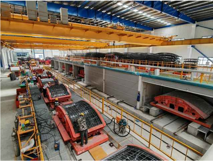
地铁管片生产线
