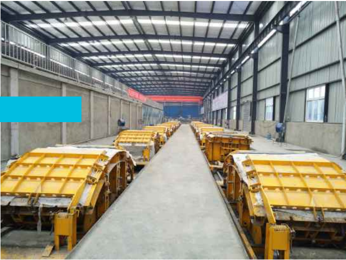
地铁管片生产线
